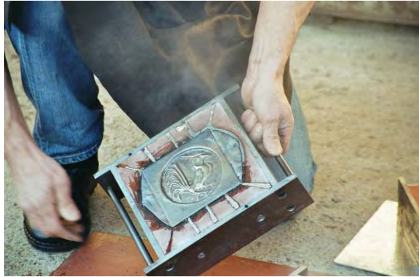
Das Gussteil mit seinen Angussbereichen und Lüftungskanälen
